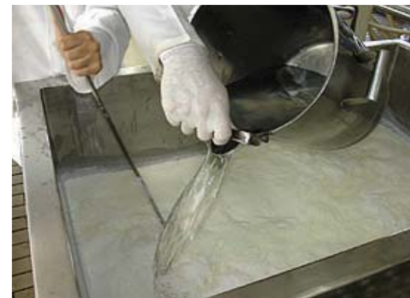
Tanque de recepção e coagulação do leite
