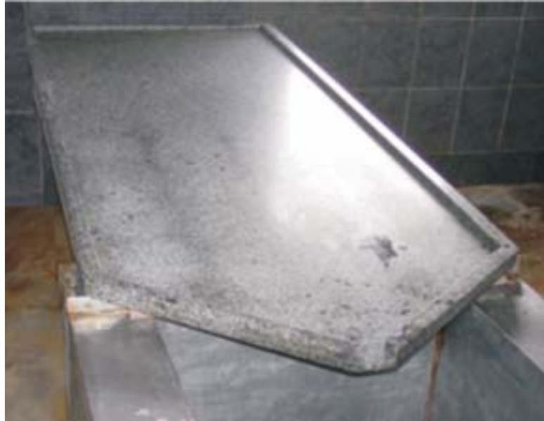
Mesa de ardósia usada durante a fabricação dos queijos e na dessoragem
